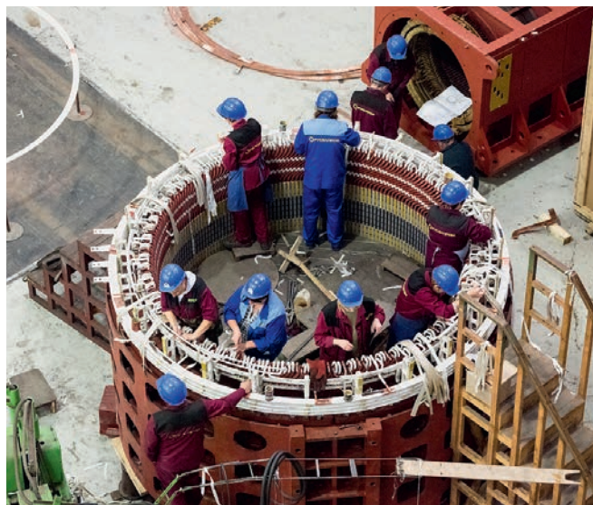
Сборка статора гребного электродвигателя для атомного ледокола проекта 22220
