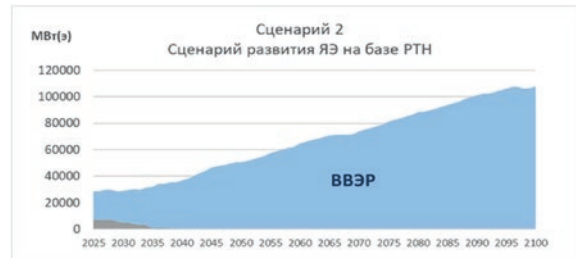
Рост установленной мощности АЭС с развитием только на базе ВВЭР
